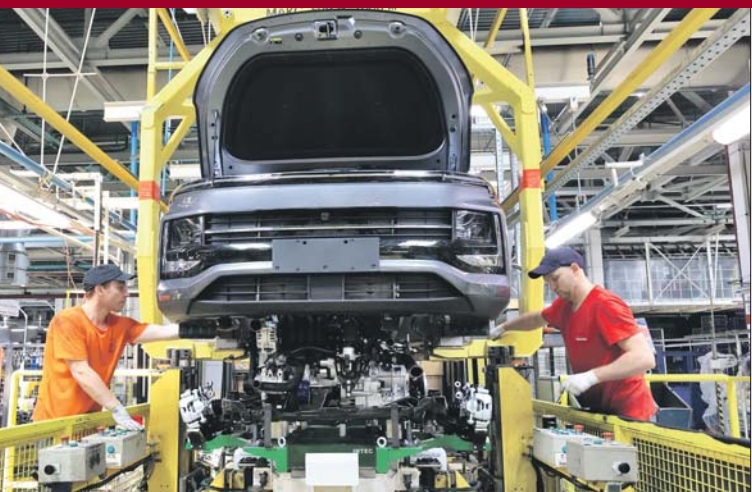
Пост «свадьбы» — соединение кузова и двигателя
