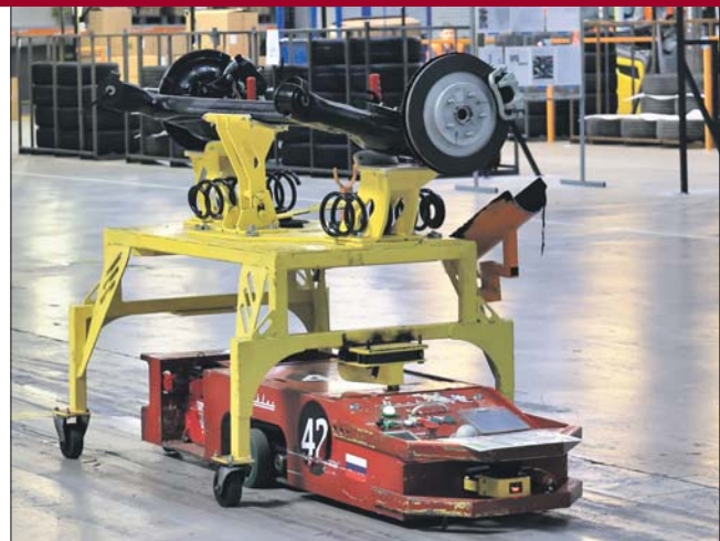
Узлы на конвейер доставляют роботы
