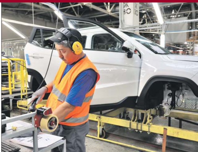
Работник считывает штрихкод, где содержатся параметры сборки
