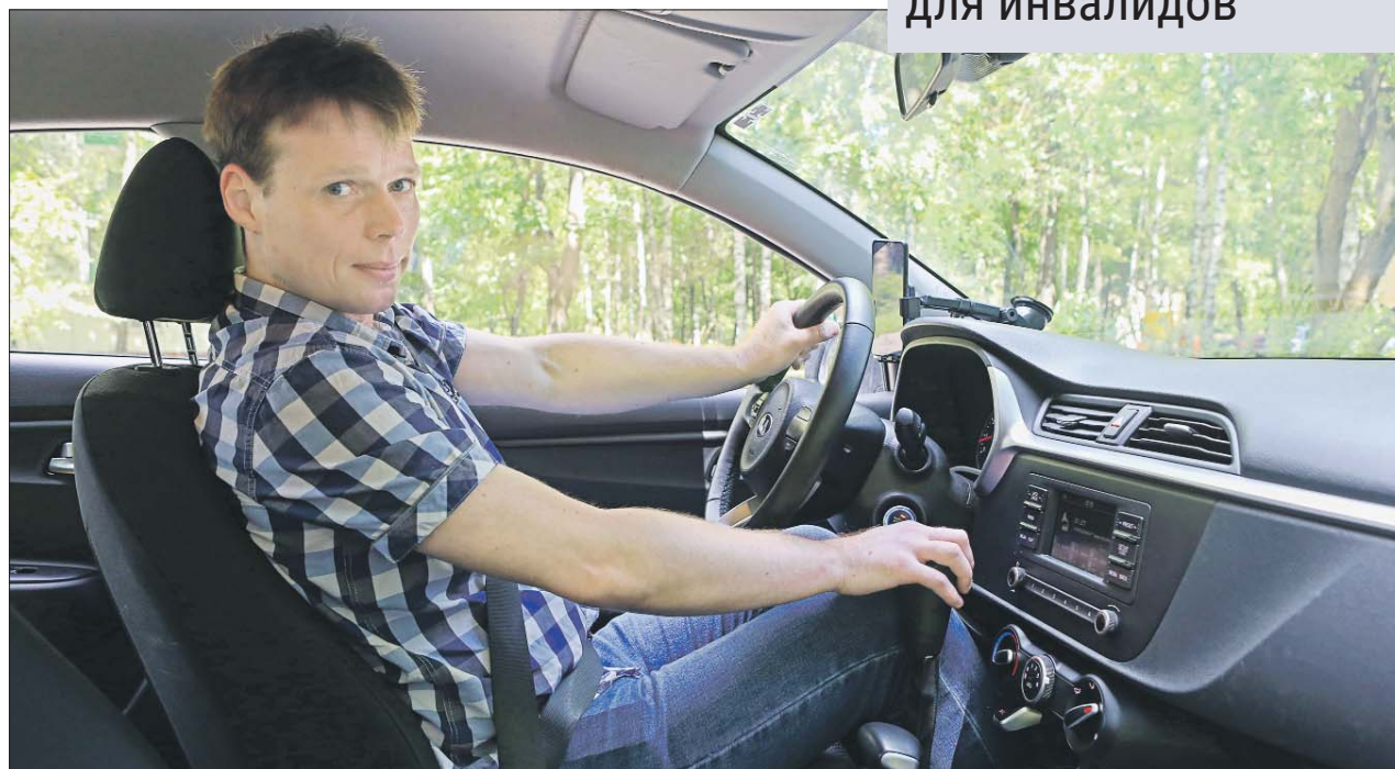
Автомобиль разгоняется и тормозит с помощью рычага
