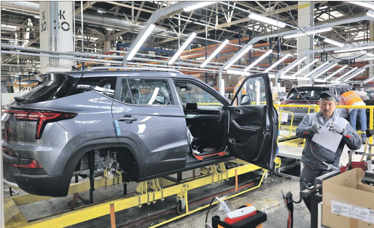
После присвоения VIN-номера к автомобилю начинают подбирать комплектующие для сборки
