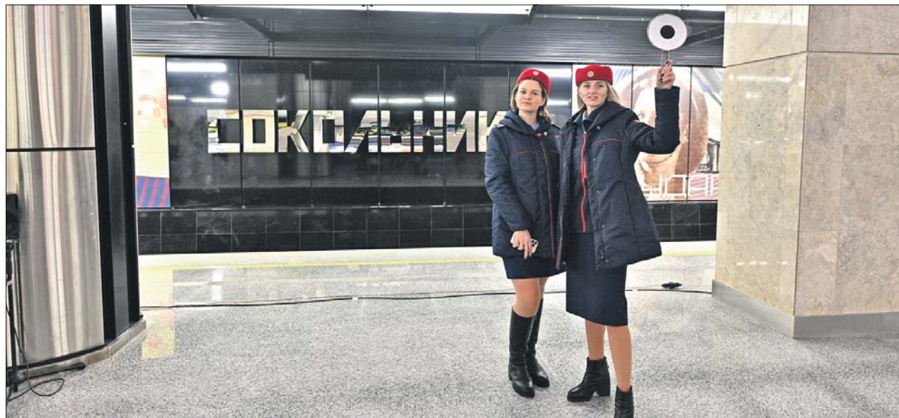
Станцию БКЛ «Сокольники» построили по традиционной технологии: островная платформа и два тоннеля
