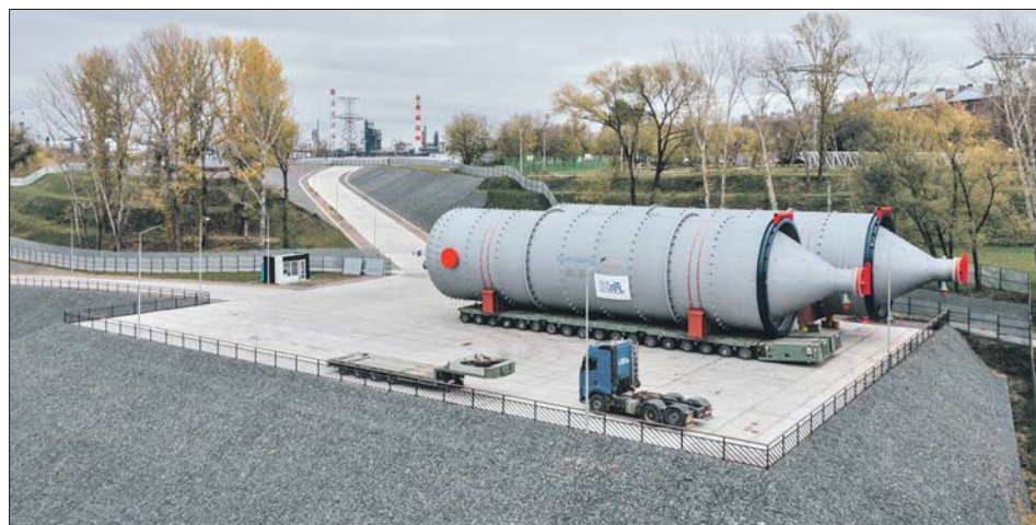
Колонны, весом 640 тонн каждая, привезли на завод по воде
