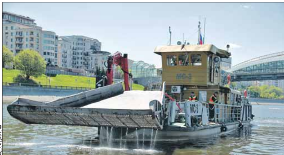
Теплоход-мусоросборщик вылавливает мусор из воды сетчатым ковшом
