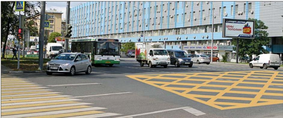
Один из вариантов нанесения вафельной разметки на перекрёстке
